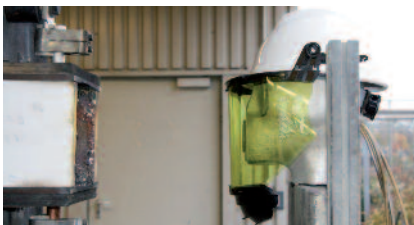
Kit de protection MSA avant le test à l'arc électrique en chambre d'essai 7 kA
