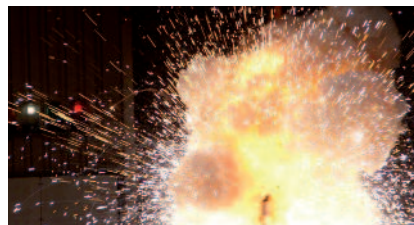
Arc électrique 7 kA
